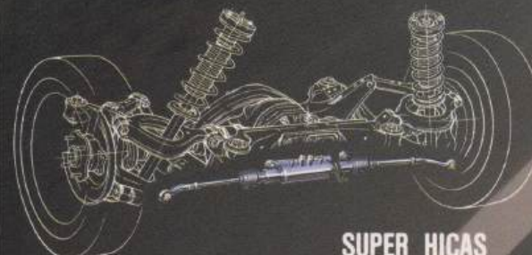
SUPER HICAS システム構成図
