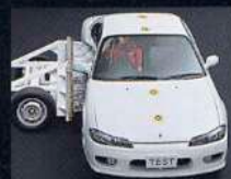
●試作車両による側面衝突実験 実際の衝突時の状態は、衝突の際のエネルギーや衝突の方向などさまざまな条件により変わってきます。
