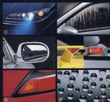
①キセノンヘッドランプ（ロービーム、レベライザー付）②ロングライフ撥水ガラス（ドアガラス）③チタンクリア®ドアミラー④ハイマウントストップランプ（左リヤスポイラー組込み、右リヤパーセル置き）⑤リヤコンパニランプ組込みフォグランプ⑥撥水ウインドウシステム（ディーラーオプション）
