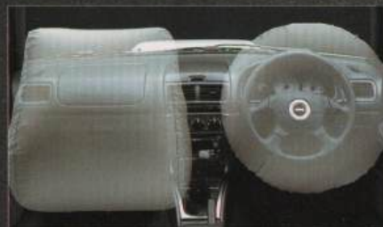
デュアルSRSエアバッグ作動イメージ
