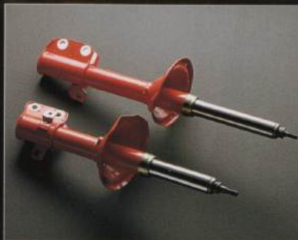
倒立式ストラット(2ステージリニアコントロールバルブ付ダンパー)
