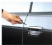
集中ドアロック(VZ, TE, M, L, M) メインキーに起小形の赤外線発信装置を組み込んであり、ボタンを押すだけでドアロックの解除・解除が遠隔操作です。
