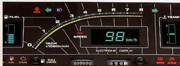
エレクトロニクスディスプレイメーター (2F7GT APEXに標準装備、2F7GT APEXにオプション) *写真は機能説明のためにランプを点灯したもので、実際の走行状態を示すものではありません。
