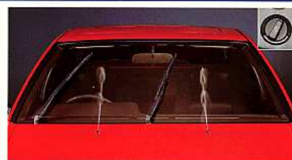
ウォッシャー連動・時間調整式間欠ワイパー (GT APEX、2F7GTVCに標準装備) ウォッシャーは2ウェイノズルでワイパー連動式。またワイパーは2秒〜7秒の範囲で作動間隔を微調整できるハイレベルの間欠機構つき。雨天時でも、前方視界はクリアだ。
