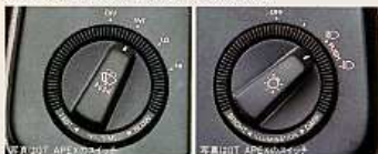
メータークラスター組み込みスイッチ (全車に標準装備) ワイパーとウォッシャー、ライティングのスイッチをメーターパネルの両側に設置。操作しやすいロータリー式を採用した。さらに、GT APEXと2F ASEは、ライティングスイッチとメーター照度コントロールを一体化した。
