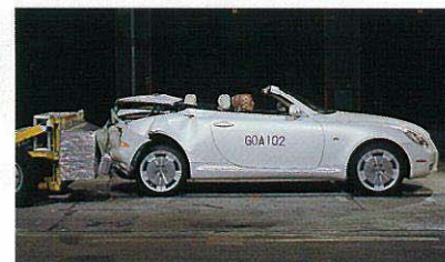
後面衝突実験 (55km/h、写真は実験用の試作車です)
